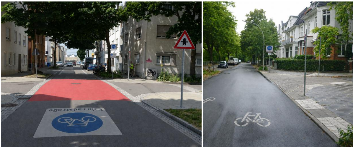
An Knotenpunkten kann die Fahrradstraße durch verkehrsrechtliche Regelungen oder bauliche Maßnahmen bevorrechtigt werden. (© difu, 2021, bearbeitet)
