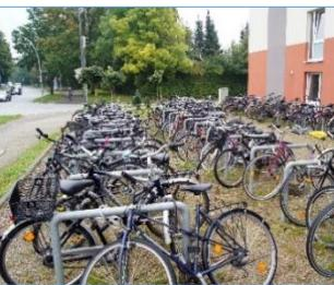
Fahrradbügel stellen eine einfache und kostengünstige Möglichkeit dar, sichere Abstellmöglichkeiten für Fahrräder bereitzustellen. Inkl. Einbau ist mit Kosten von 150-200 Euro pro Bügel zu rechnen. Fahrradbügel eignen sich auch dazu, unberechtigtes Parken von Autos zu verhindern, z.B. um Sichtbeziehungen an Kreuzungen freizulassen. Mobile Varianten eignen sich für kurzfristige Maßnahmen, z.B. auf Stadtfesten.
